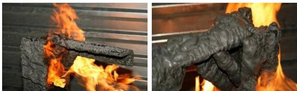
Рис. 6. Образование слоя спекшейся корочки на поверхности металлического изделия при тушении порошковым составом
