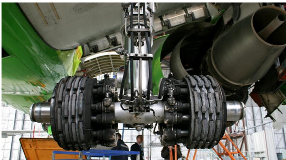
Рис. 4. Магниевые тормозные диски шасси самолета
