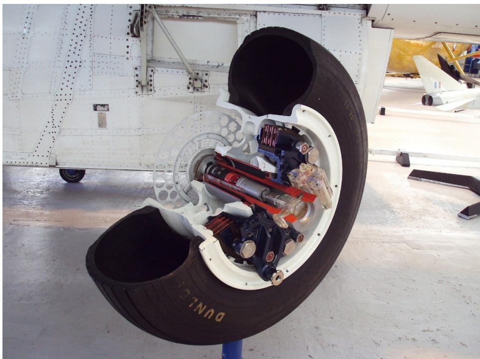
Рис. 3. Внутреннее устройство колеса самолета с многодисковым тормозом
