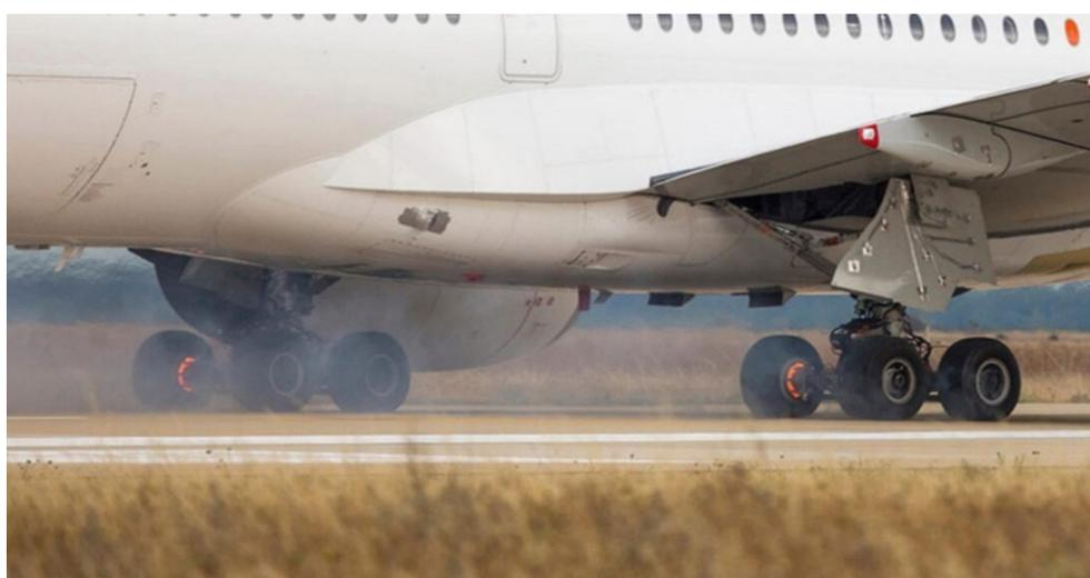
Рис. 5. Раскаленные тормоза самолета после экстренного торможения
